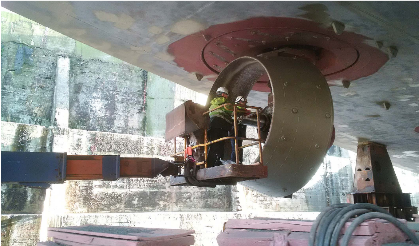
Onderhoud aan de roerpropellers van ms. 'Dokter Wagemaker' tijdens de in november 2018 bij Damen Shiprepair Amsterdam uitgevoerde dokbeurt
